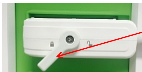
Figura 28. Orientación del conector del transductor
