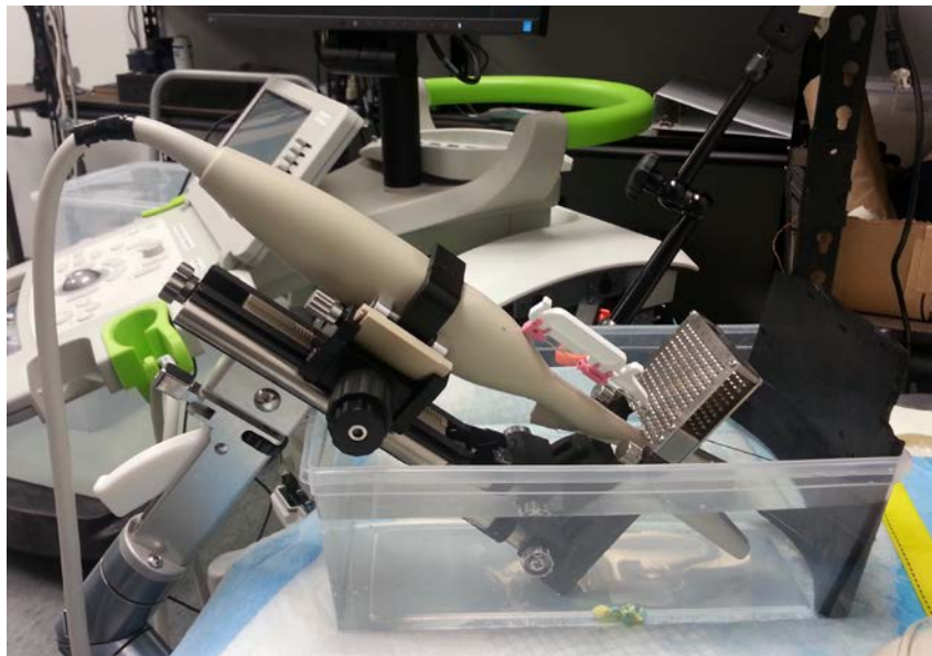
Figura 41. Transductor y posicionador transperineal en el baño de agua
